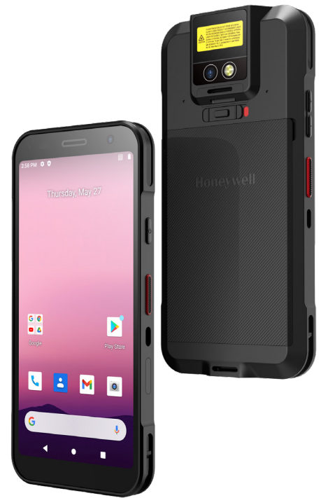
O CT32: Computador móvel 5G na plataforma Mobility Edge™, mecanismo de leitura 5G + Wi-Fi 6E, S0703 ou S0803, elegante, durável e com longo ciclo de vida
